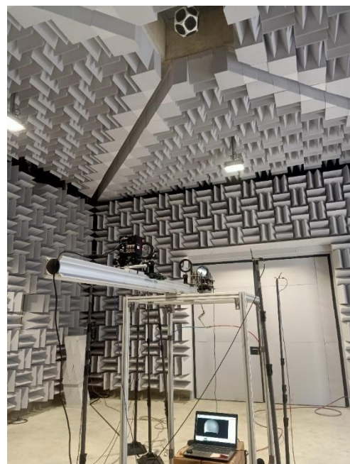
Figure 1 : Brûleur annulaire ANO à l'Institut Pprime : Image schlieren instantanée d'une flamme H_2 -air pré-mélangée à une richesse de 0,4 (à gauche) et brûleur installé au banc Martel (à droite).
