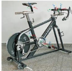
d) Ergocycle instrumenté pour l'analyse du mouvement de pédalage (RoBioSS)
