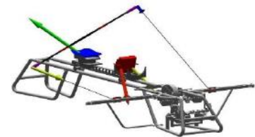
c) Ergomètre Kayak instrumenté pour la simulation de gestes sportifs (RoBioSS)
